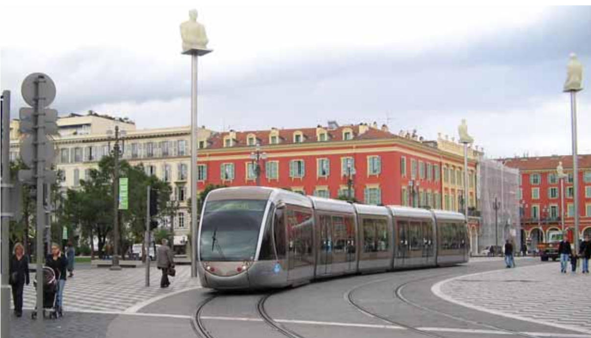
De tram rijdt bovenleidingvrij op batterijen tegen 30 km/uur op het autovrije Place Masséna. Er werd voor 3,3 miljoen euro besteed aan kunstwerken langs de tramroute.
