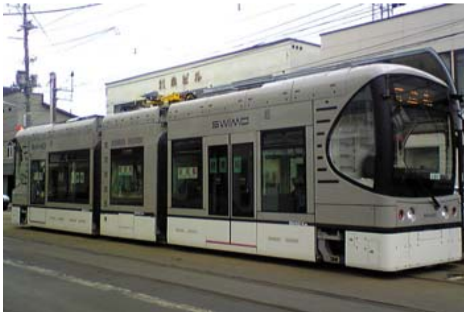
De SWIMO-tram gebruikt grote batterijen waarmee met 40 km/uur tot 10 km ver kan worden gereden op niet-geëlektrificeerde lijnen. Nadien kunnen de batterijen op 5 minuten weer worden opgeladen onder de bovenleiding.
